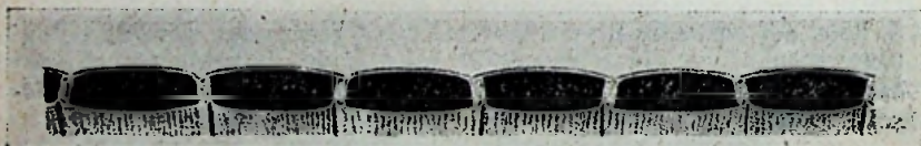
Doorsnede van een platenpakket van een Ni-Fe accu
